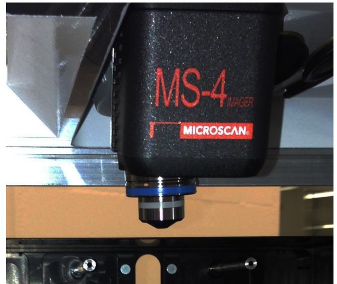
Im Inneren des EUROPattern-Mikroskops entschlüsselt der MS-4-Imager den auf die Objektträger aufgedruckten DataMatrix-Code.
