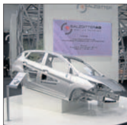
Auf dem Stand der Salzgitter AG ist unter anderem die Karosserie eines Ford Fiesta zu sehen. Sie enthält hoch- und höchstfeste Stähle aus Salzgitter, die helfen, Gewicht zu sparen.
